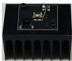
写真11 フィン下向き (空気の流れを妨げた向き)
